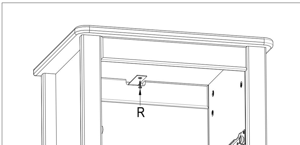
**ПРЕДУПРЕЖДЕНИЕ:** Чтобы предотвратить риск опрокидывания, шифоньер необходимо прикрепить к стене с помощью соединительной планки (O), дюбелей (S) и шурупов (P и R). Эта работа должна проводиться квалифицированными специалистами.
