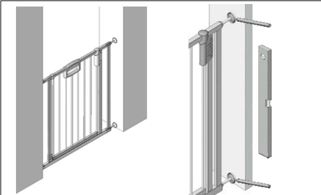
Закрепление фиксатора при помощи клейкой ленты
