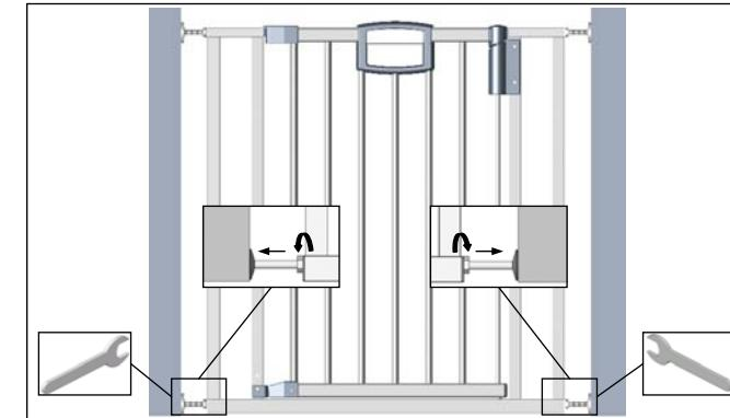
**D** Die unteren Justierschrauben bis zu den Halteschalen herausziehen und die Muttern mit Schraubenschlüssel fest anziehen.
