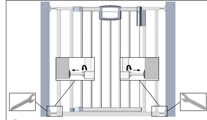
**(RU)** Выдвиньте нижние регулировочные винты до фиксаторов и плотно затяните гайки гаечным ключом.
