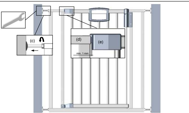
**(RU)** Выдвиньте регулировочный винт (c) до фиксатора и плотно затяните гайку так, чтобы зазор между запирающим устройством (d) и ручкой (e) составлял не менее 1 мм..
