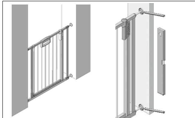
Befestigung der Halteschalen mit Klebeband
