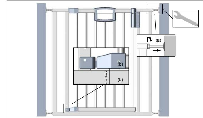
**(RU)** Выдвиньте регулировочный винт (a) до фиксатора и затяните гайку так, чтобы обе нижние перекладины (b) были параллельны друг другу.
