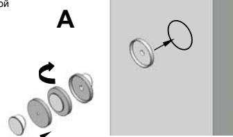
Закрепление фиксатора при помощи дюбеля
