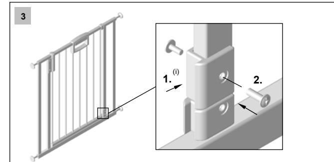
**(RU)** Дополнительный стопор (i) может использоваться в качестве предохранительного устройства, когда дверь должна открываться только в одну сторону. Его нужно установить так, чтобы ворота не открывались в опасную зону.
