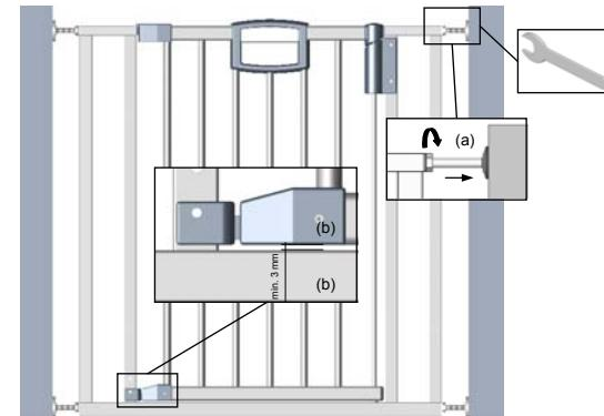
**D** Justierschraube (a) bis zu der Halteschale herausziehen und die Mutter anziehen bis die beiden unteren Holme (b) parallel sind.
