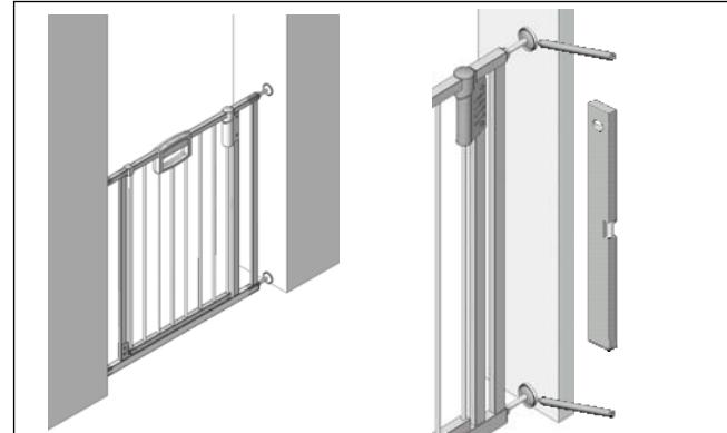
Закрепление фиксатора при помощи клейкой ленты.
