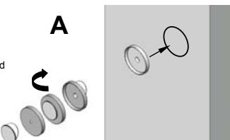
Befestigung der Halteschalen mit Dübel
