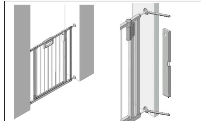
Befestigung der Halteschalen mit Klebeband
