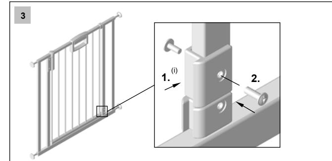
**(RU)** Дополнительный стопор (i) может использоваться в качестве предохранительного устройства, когда дверь должна открываться только в одну сторону. Его нужно установить так, чтобы ворота не открывались в опасную зону.
