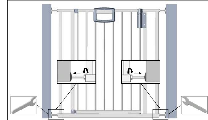
(FIN) Vedä alempat asetusruuvit ulos kiinnitysheloihin asti ja kiristä mutterit ruuviavaimella.
