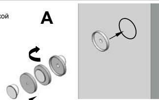
Закрепление фиксатора при помощи дюбеля.
