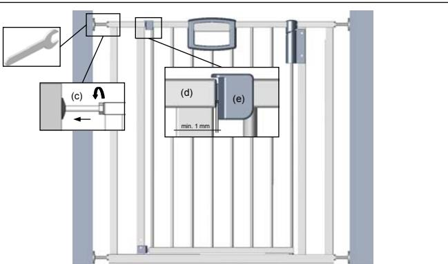
**(RU)** Выдвиньте регулировочный винт (c) до фиксатора и плотно затяните гайку так, чтобы зазор между запирающим устройством (d) и ручкой (e) составлял не менее 1 мм.
