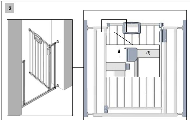
**(RU)** Приподнимите дверь (f) и распахните её в нужном направлении. При открытии ворот на угол более 90° (g) дверь сохраняет свое положение. Закройте дверь, не приподнимая её.
