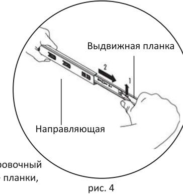
Закрепить направляющие, надавив на деблокировочный рычаг (рис. 3 и 4), снять внутренние выдвижные планки, отложить их до сборки ящиков. Направляющие установить на детали (дет. 1 и 2) и согласно отверстиям на деталях закрепить с помощью саморезов 3,5x16 (№ 105).
