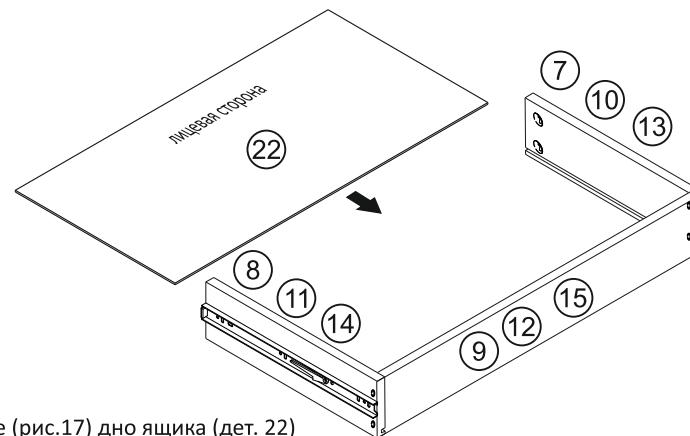
Согласно схеме (рис.17) дно ящика (дет. 22) установить в паз до упора.
