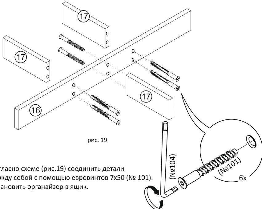
Согласно схеме (рис.19) соединить детали между собой с помощью евровинтов 7x50 (№ 101).
