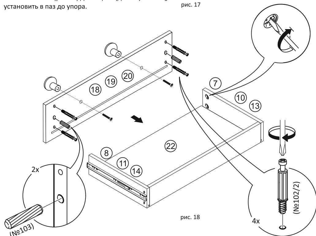
В фасаде (дет. № 19, 20) установить шканты (№ 103) и ввинтить дюбель стяжки (№ 102/2). Соединить детали, как показано на рисунке 18. Затянуть эксцентрик. На фасад установить ручку, закрепить с помощью винта в комплекте.
