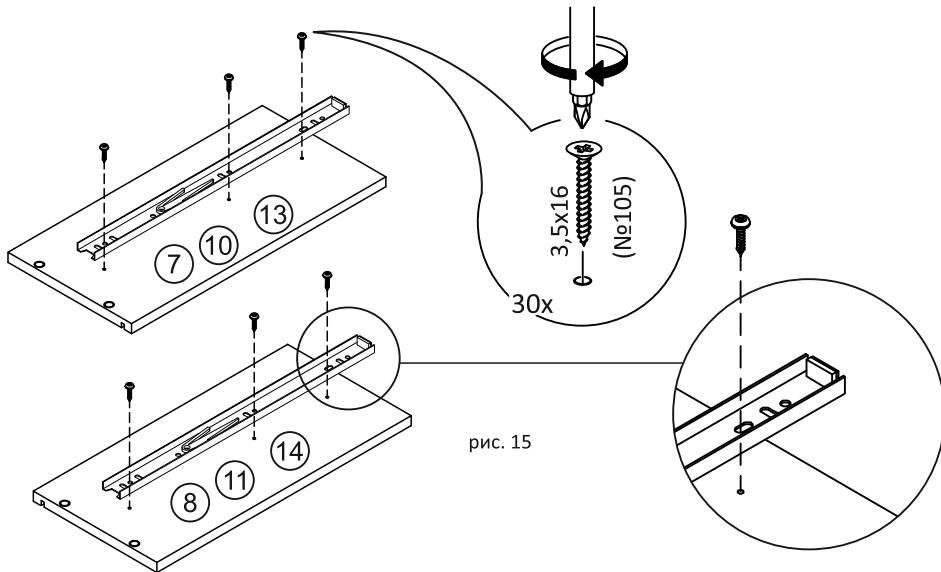
Выдвижные планки направляющих (№ 106) установить изогнутой частью к основанию боковых стенок со стороны, где будет установлен фасад (рис. 15), закрепить с помощью саморезов 3,5x16 (№ 105).
